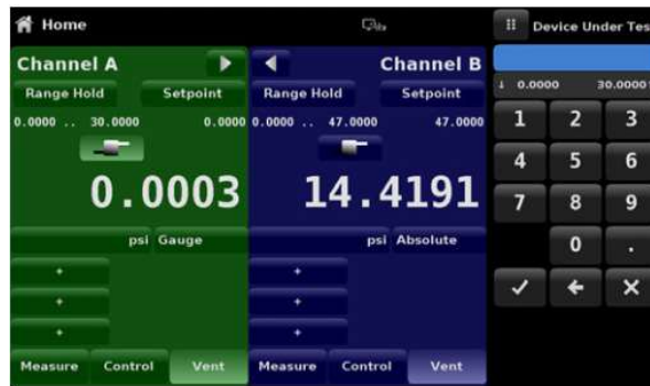
Rys. 8.9.2.3-C - Ciśnienie urządzenia testowanego podczas sekwencji oczyszczania
