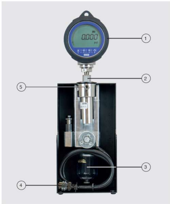
Rys. 8.9.2.1-B - Montowane od góry urządzenie testowane
