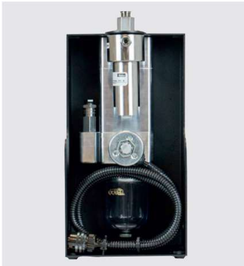
Rys. 8.9.2 - System automatycznego zapobiegania zanieczyszczeniom
