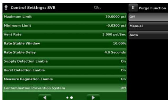
Rys. 8.9.2.3-B - System zapobiegania zanieczyszczeniom
