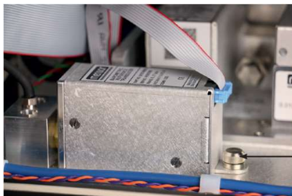
Rys. 9.3.2.1 - Wewnętrzny wzorec barometryczny
