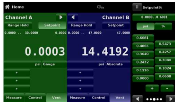
Rys. 6.4.1.2.3-B - Wprowadzanie wartości ciśnienia urządzenia testowanego
