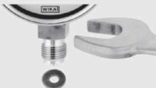
Для уплотнения цилиндрической резьбы используйте плоские прокладки, уплотнения типа "линза" или профилированные уплотнения WIKA ①. Уплотнение конической резьбы (например, резьбы NPT) осуществляется по резьбе ② с использованием подходящего уплотнительного материала (EN 837-2).
