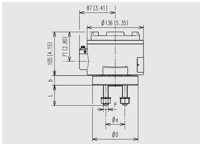
Вариант фланца "S" имеет фиксированные метрические шпильки, в комплект поставки входят гайки и шайбы.
