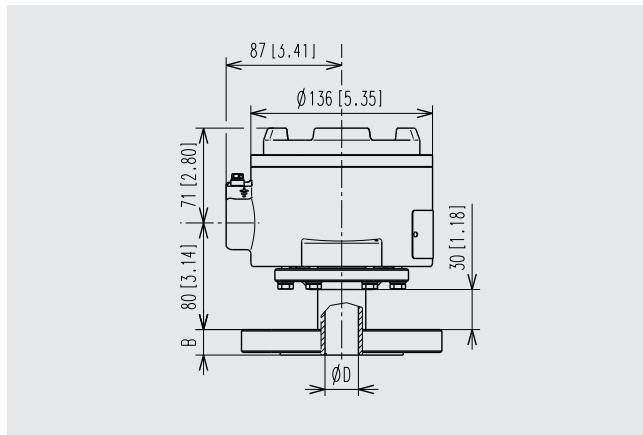
Вариант фланца "Т" имеет удлинительную трубу, позволяющую монтировать стандартные фланцевые соединения.
