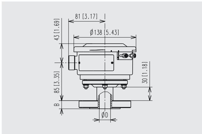
La variante de bride "T" est munie d'un tube d'extension pour permettre l'installation des raccords de bride standard.
